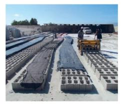
Impianto di produzione di blocchetti in cemento prefabbricati per edilizia abitativa e pavimentazione stradale.
